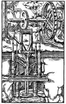
Die obere Welle A. Das Wafferrad, das durch das Bachwaffer getrieben wird B. Das Zahnrad C. Die untere Welle D. Das Getriebe E. Die Krummzapfen F. Die Gruppen von Pumpenfärten G.
